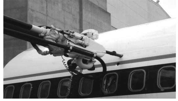
Şekil 2 Uzatmalı Çatı Monitörü ile havalandırma deliği açma [10]
