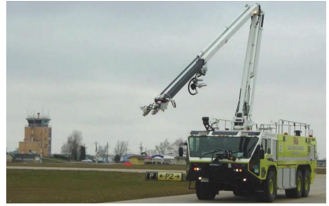
Şekil 1 Uzatmalı Çatı Monitörü [2]
