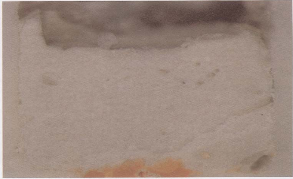
Resim 1: Çinko fosfat siman grubunda 1 değerinde sızıntı (x 25).
