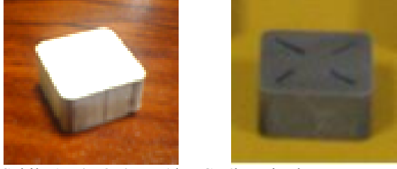
Şekil 1 a) 250MPa'da CIP'lenmiş ham numune b) 1750°C'de 2 saat sinterlenmiş numune
