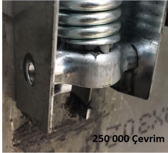
Şekil 10. Alternatif tasarımla ile 1,5 mm standart sacdan üretilmiş modelin dinamik laboratuvar testi (250 000 çevrim)
