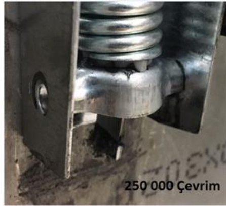
Şekil 12. (B) Alternatif tasarımla geometrinin yük taşıyan hacminin ve yüzeylerinin artırılması ile 1,5 mm standart sacdan üretilmiş modelin dinamik laboratuvar testi (250 000 çevrim)
