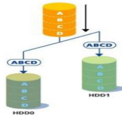
Şekil 3: RAID 1 Çalışma Mantığı Şekilsel Gösterimi
