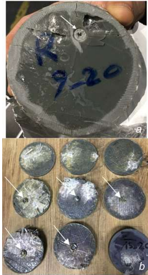
Şekil 11. Atışlar sonrası numuneler a)R silindirik kompozit b)Tüm silindirik kompozitler.
