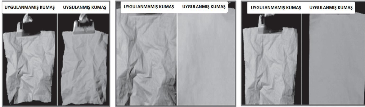
Kırışık Kumaşlar → Kumaşların üzerine buhar üfleme → Uygulanmış kumaşın kırışıklığının düzelmesi.
