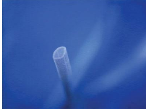
Şekil 2. İçi boş lifin enine kesitinin görünümü (Meng ve ark., 2009).
