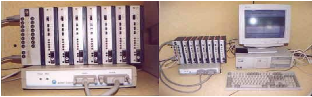
Şekil 4. Sinir ileti hızlarının ölçümünün yapıldığı komputeze elektromyografi cihazı
