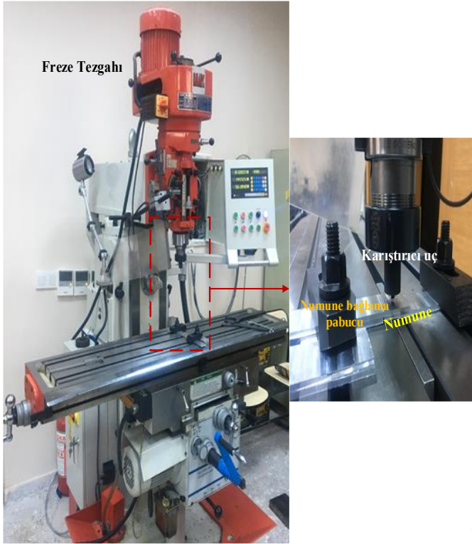
Şekil 3. Kaynak işlemlerinin yapıldığı Freze tezgâhı
