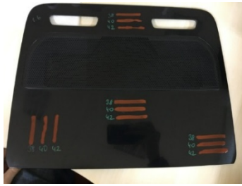
Şekil 7. Kurubuz ile temizlik sonrası yüzey gerilimi ölçümü
