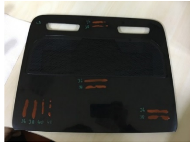
Şekil 6. Fırınlama sonrası yüzey gerilimi ölçümü
