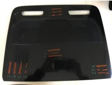
Şekil 5. Alkol ile silme sonrası yüzey gerilimi ölçümü
