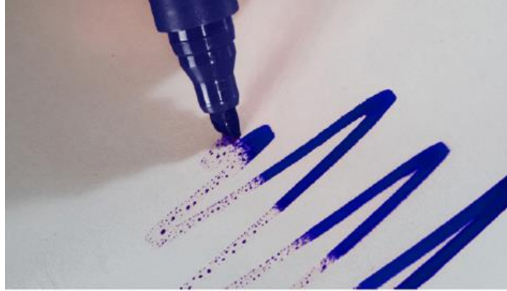
Şekil 3.İyi ve kötü yüzey ıslanması
