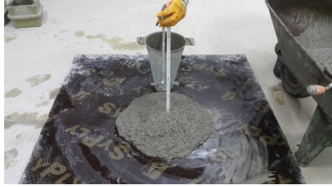
Şekil 13. S4 kıvam sınıfının kontrolü için çökme deneyinin uygulandığı sahne
