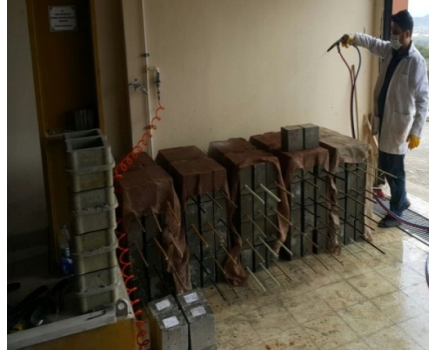
Şekil 21. Üretilen mafsallı kirişlere ıslak çuvallarla kür uygulanması
