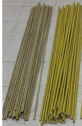
Şekil 9. Deneysel çalışmada kullanılan kumlanmış (sol) ve helisel sargılı (sağ) aramid lifli kompozit donatılar
