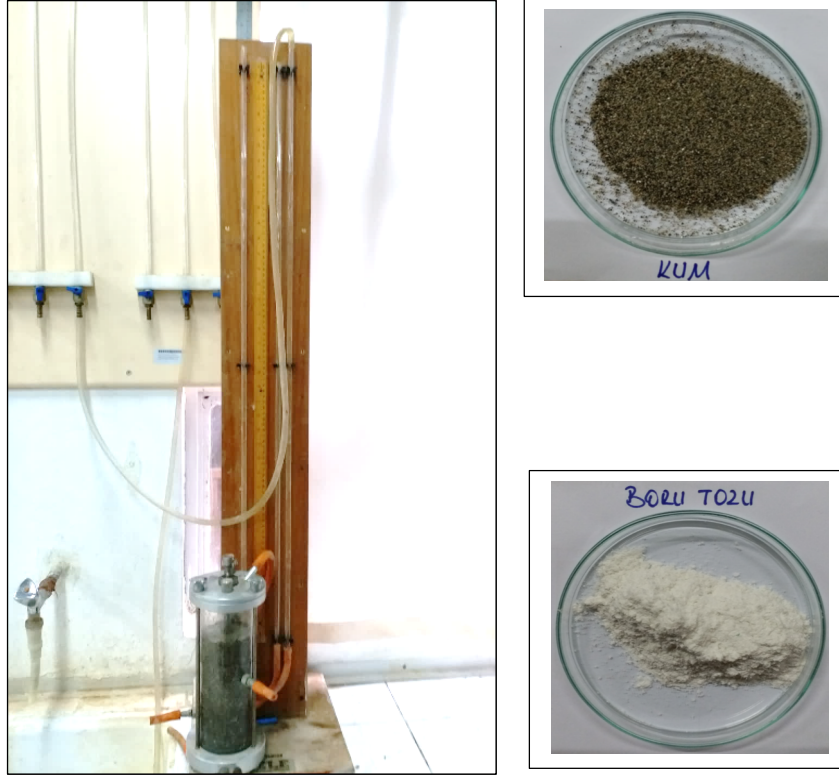
Şekil 3. Permeabilite deney düzeneği ve kum zemin-atık boru tozu
