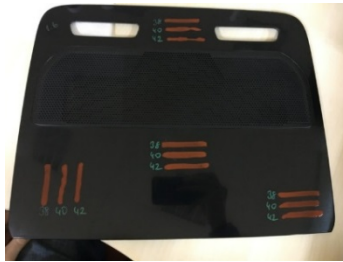
Şekil 7. Kurubuz ile temizlik sonrası yüzey gerilimi ölçümü
