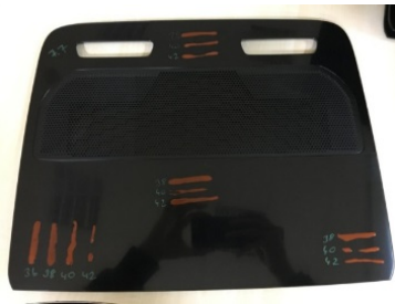
Şekil 5. Alkol ile silme sonrası yüzey gerilimi ölçümü
