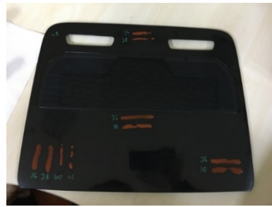
Şekil 6. Fırınlama sonrası yüzey gerilimi ölçümü
