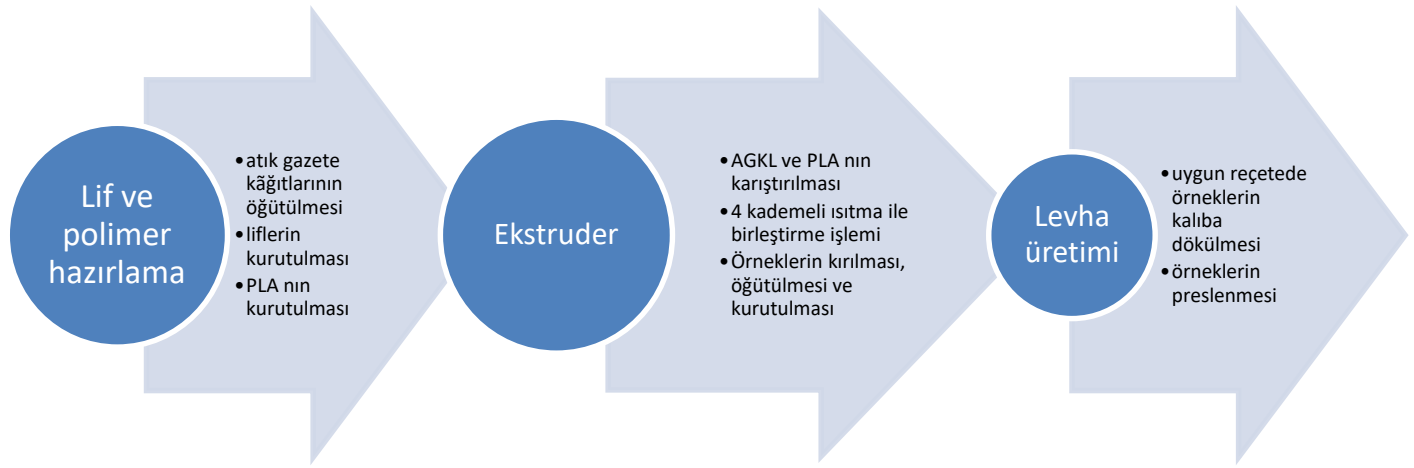
Şekil 1. Lignoselülozik dolgu termoplastik kompozit levha üretim şeması
