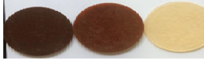
Şekil 3. Dökülmüş ve işlenmiş kompozit ses yutma numunesi (çap100 mm)
