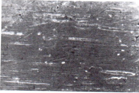
Resim 7: 45 dakika etching işlemi yapılan Cr-Co alaşımı. Büyütme x 600
