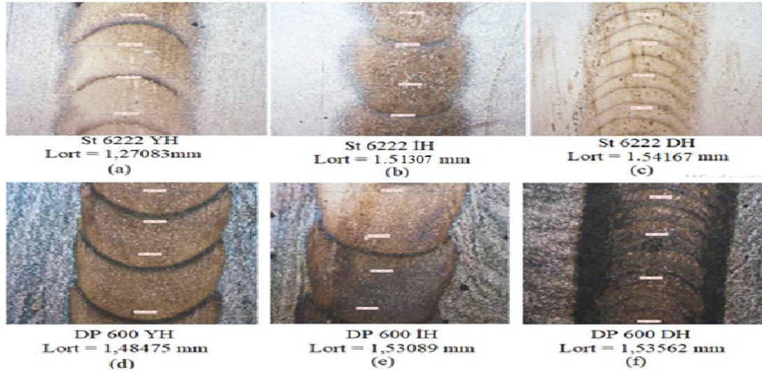
Şekil 3. Kaynak hızının kaynak dikişine etkisi (200X)
