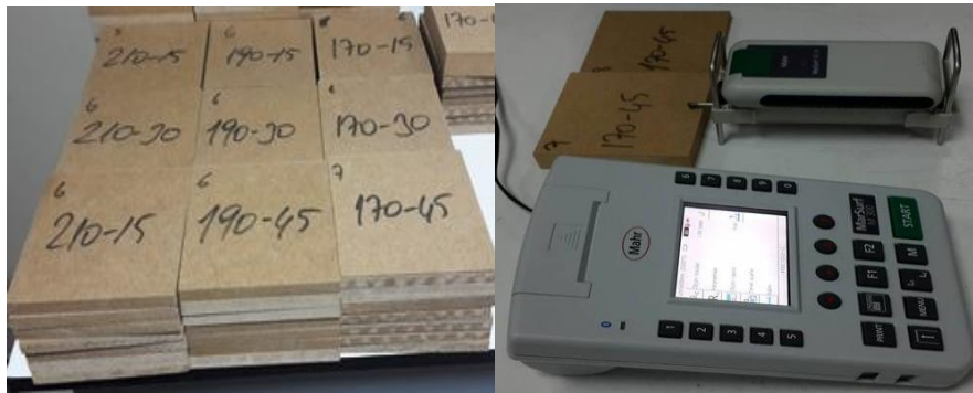
Şekil 1. Yüzey Pürüzlülük cihazı (Marsurf M300) ve MDF Test Örnekleri
