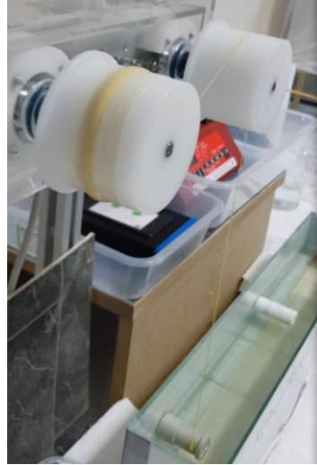
Şekil 2c. Viskoz Rayon Liflerinin Godetlere Sarımı
