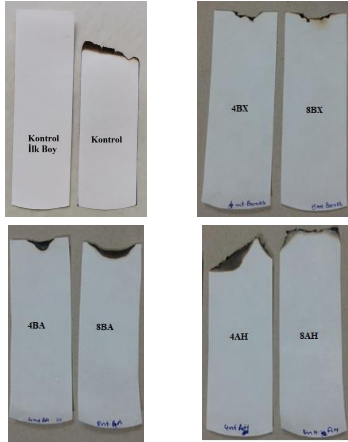
Şekil 8: BA, BX, AH kimyasallarının filtre kâğıdında süzöldükten sonra yanma görüntöleri
