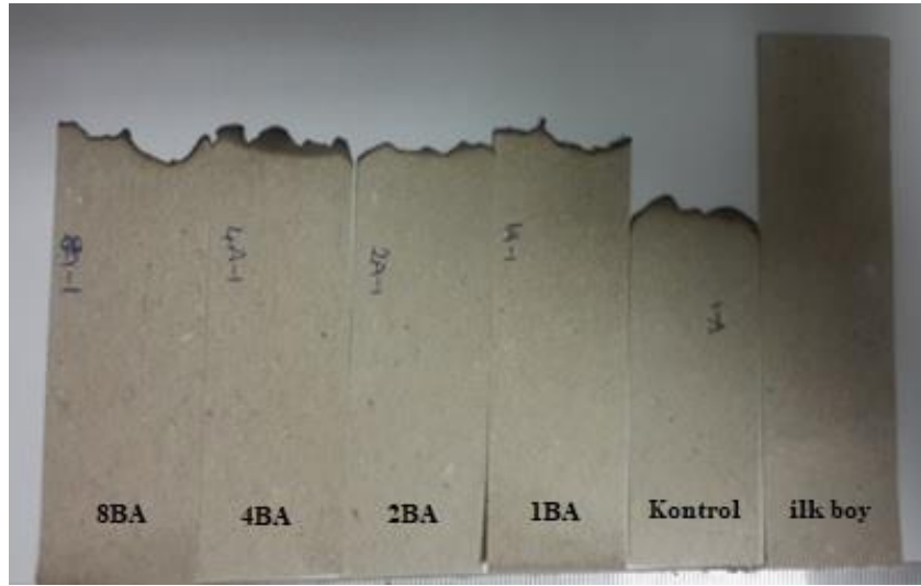
Şekil 4: BA kullanılan kâğıtların 5 sn yandıktan sonraki yanma görüntüleri
