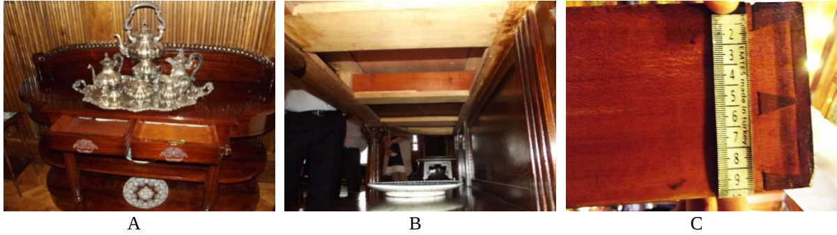
Şekil 12. A- Konsolun fonksiyonel görünümü, B- Konsolun çekmece altı bölümünden bir görünüm, C- Konsola ait çekmece Kırangıçkuyruğu dişli birleştirme detayı.
