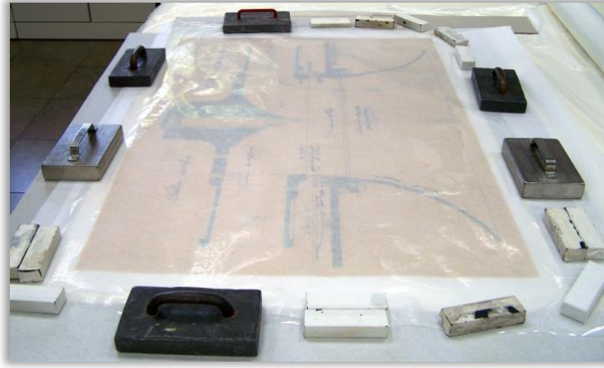
Şekil 14: Aydınır kâğıtta nemlendirme /terletme yöntemi.
