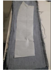
Resim.31.Alt Kol Kalıbın Kumaşa Yerleştirilmesi
