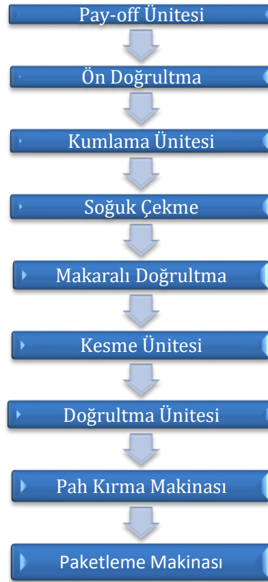
Şekil 1: Soğuk çekme hattı akış diyagramı
