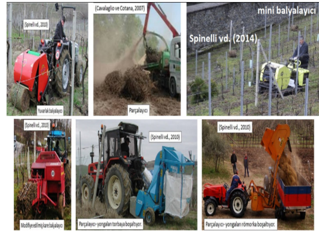
*Yuvarlak balyalayıcı / The round baler, Parçalayıcı / The shredder, Mini balyalayıcı / The mini baler, Modifiye edilmiş kare balyalayıcı / The modified square baler, Parçalayıcı yongaları torbaya boşaltılıyor / The shredder is discharging chips into the bag, Parçalayıcı yongaları römorka boşaltılıyor / The shredder is discharging chips into the trailer
