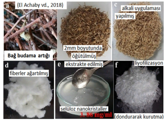
Bağ budama artığı / The vineyard pruning residue, 2 mm boyutunda öğütülmüş / Milled to 2 mm size, Alkali uygulaması yapılmış / Alkaline application was done, Fiberler ağartılmış / The fibers bleached, Liyofilizasyon (dondurarak kurutma) / Lyophilization (freeze drying)
