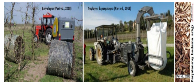
Balyalayıcı / The baler, Toplayıcı - parçalayıcı / The collector - shredder, Parçalanmış budama artığı / The shredded pruning residue
