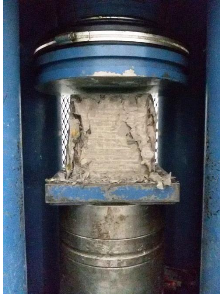
Şekil 4. Beton numunelerinin basınç dayanımı testi
