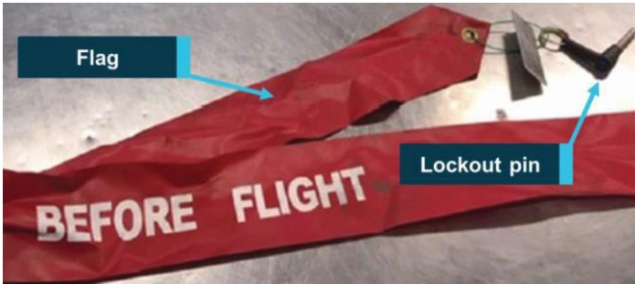
Şekil 6. 18 Aralık 2017’de Jetstar Airways’ ait Airbus A320-232’de hat bakım sonrası unutulmuş ve uçuştan sonra tespit edilmiş bir FOD örneği [AA2,2017].
