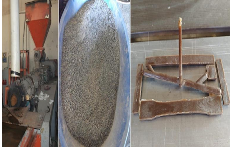
Şekil 1. Malzeme Karışımlarının Extrüder - Kırma Ve Enjeksiyon Makinasında Üretilen Deney Numuneleri Aşamaları
