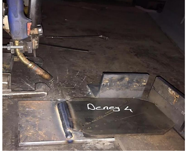
Şekil 3: Deney İşlemi Gerçekleştirilmiş Parça Görünümü
