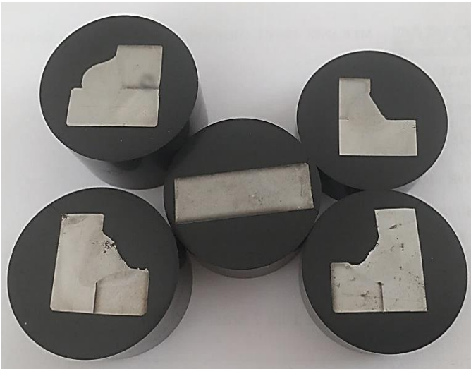
Şekil 6: Bakalit Kaplanan Deney Numuneleri
