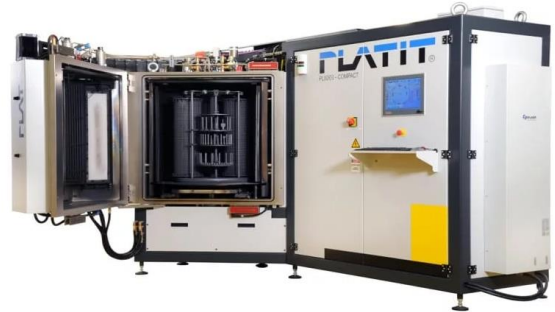
Şekil 1. Katodik ark buharlaştırma kaplama düzeneği
