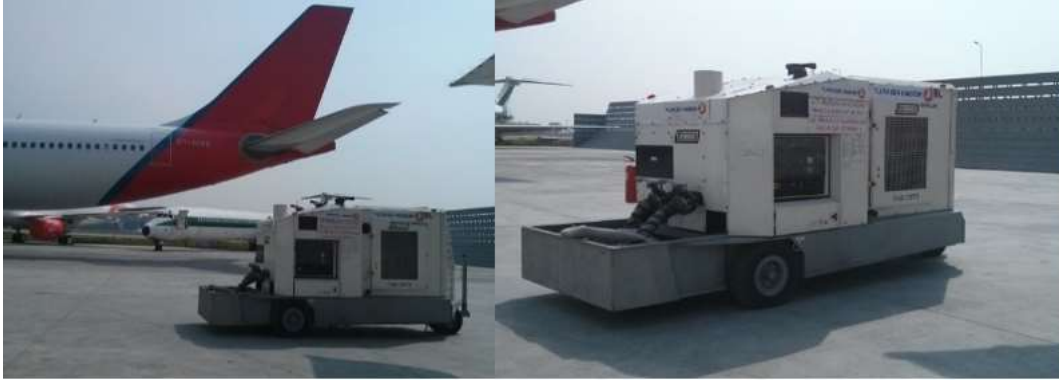
Şekil 2. Harici Hava Üreten Jeneratör
