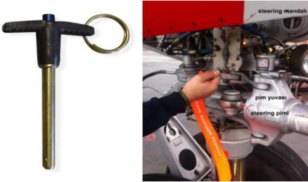
Şekil 12. Steering Pimi ve mekanizması
