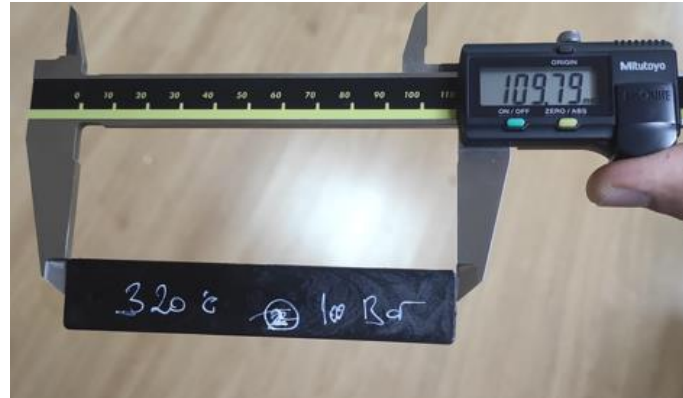
Şekil 4. Plastik Numunenin Ölçüsel Hata Kontrolü
