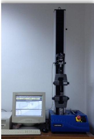
Şekil 3. Bağlanma dayanımı testi
