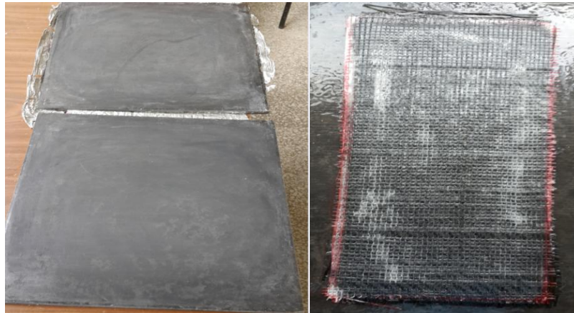
Şekil 1. Kullanılan kalıp ve reçine sürülmüş elyaflar
