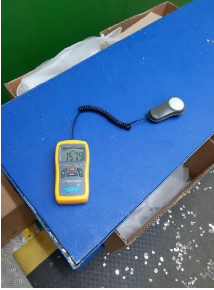
Şekil 4. Çalışma Alanında Aydınlatma Şiddeti Ölçümü
