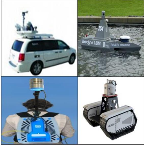
Şekil-2: Mobil Lidar Platformları
