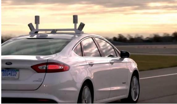
Şekil-8: Ford Focus Lidar İnsansız Aracı.
