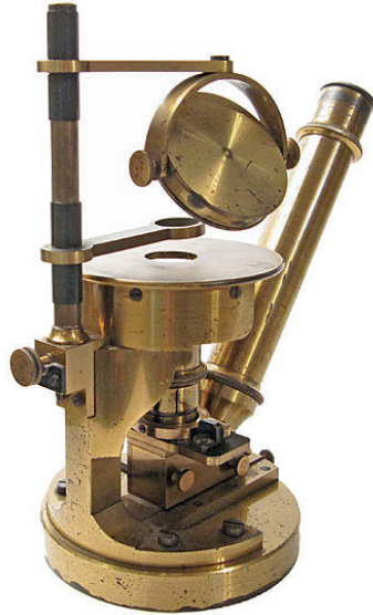
Fotoğraf 2. Smith'in çizdiği modellerden 1852 yılında Nachet firması tarafından üretilen ters mikroskop. http://www.antique-microscopes.com/photos/Nachet_Chemical_Inverted_microscope.htm
