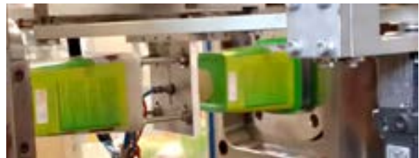
Fotoğraf 5a. IML Robot sistemleri ile kalıp içerisine etiket yerleştirilişi (MFM Mühendislik).
