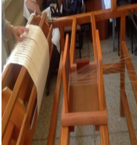
Fotoğraf 15. Atölye ortamında çözgü hazırlama (KK 2, 27 Ağustos 2014, Eskişehir Olgunlaşma Enstitüsü)
