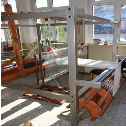
Fotoğraf 16. Çözgünün tezgaha aktarılması
