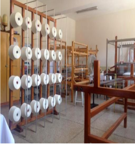
Fotoğraf 15. Atölye ortamında çözgü hazırlama (KK 2, 27 Ağustos 2014, Eskişehir Olgunlaşma Enstitüsü)
