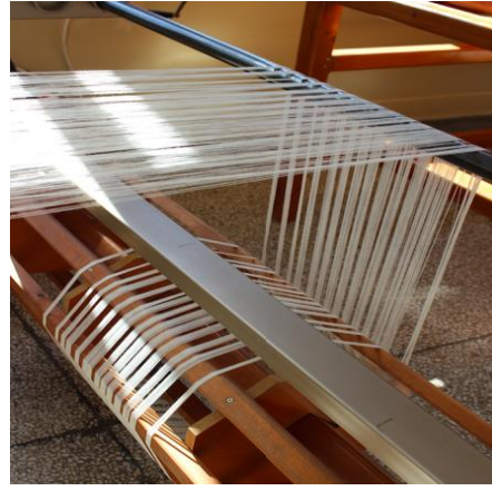
Fotoğraf 16. Çözgünün tezgaha aktarılması
