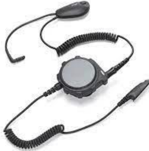
Şekil.4 Telsiz Bağlantı Aparatı
