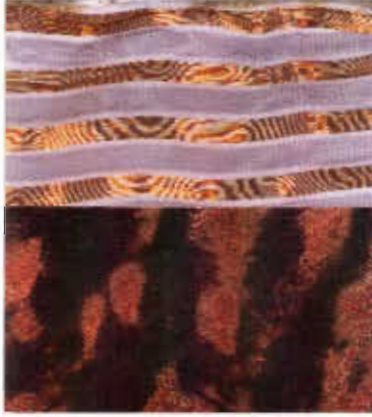
Resim 1: Bakır tel ve sentetik liflerle dokunmuş iki kumaş Kaynak: Braddock & O'Mahoni, 1998, s.20
