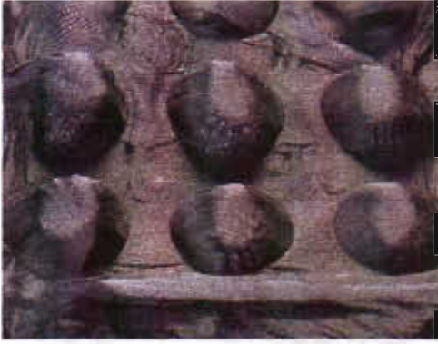
Resim 9: Yüksek ısıyla kalıcı olarak hacimlendirilmiş polyester kumaş
