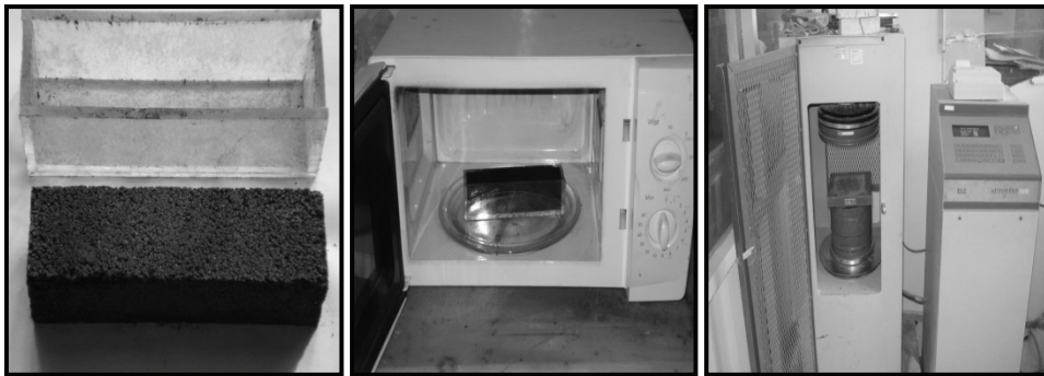
Şekil 1. Cam kalıp, mikrodalga fırın (1200 W, 2450 MHz) ve basınç pres (200 ton)
