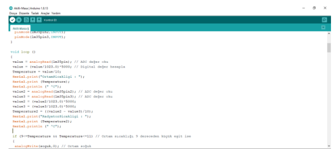
Şekil 4. Arduino IDE kod editöründe yazılan radyasyon kapı kontrolü programı
