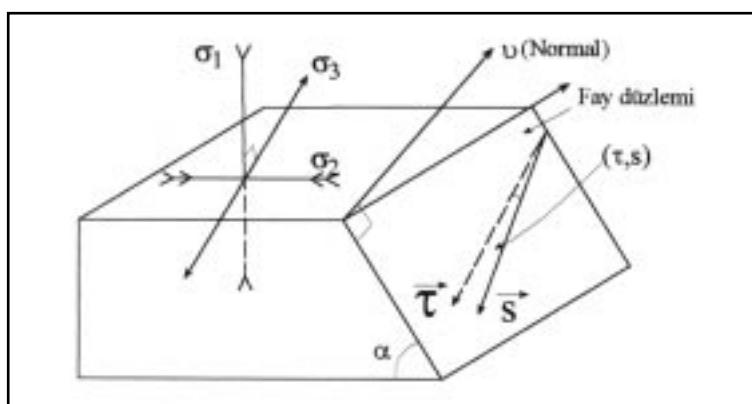
Şekil 3. Bir faya ait blok diyagram üzerinde öngörülen kayma vektörü ( $\tau$ ) ile ölçülen kayma vektörü ( $s$ ) arasındaki açı ( $\sigma_1$ ,  $\sigma_2$  ve  $\sigma_3$  sırasıyla sıkışma, ortaç ve genişleme ana gerilme yönleri.  $v$ : düzlemin normalidir).
