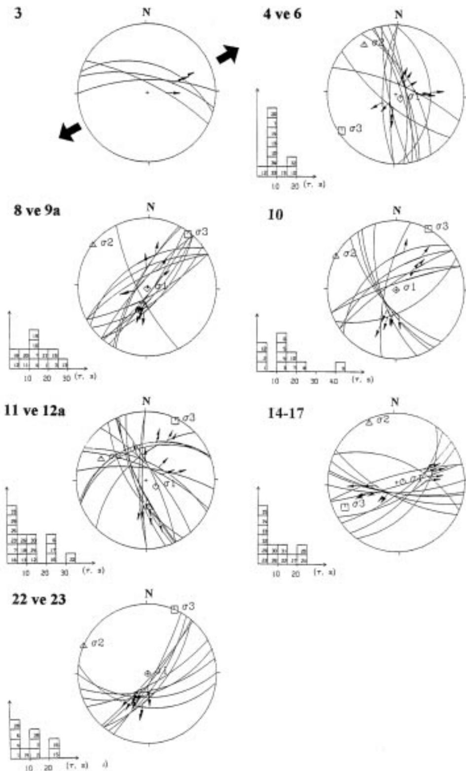
Şekil 8. Çizelge 3'de verilen açılma rejimine ait lokasyonlarda gerçekleştirilen kinematik analiz sonuçlarının eşit açılılı alt yarımküre (Wulf) üzerinde izdüşümü.
