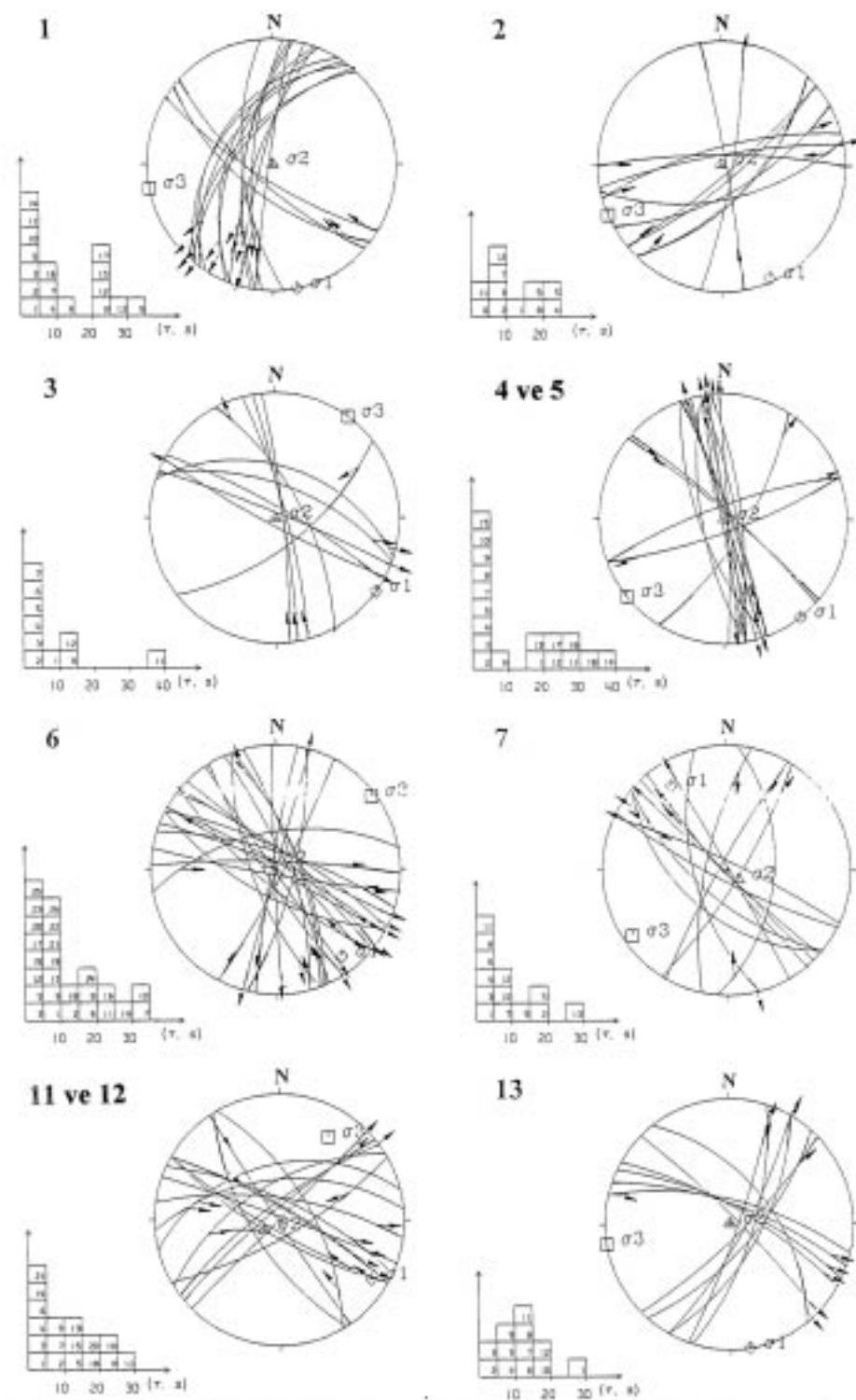
Şekil 6 a. Çizelge 2'de verilen doğrultu atımlı gerilme rejimine ait lokasyonlarda gerçekleştirilen kinematik analiz sonuçlarının eşit açılı alt yarımküre (Wulf) üzerinde (öngörülen kayma vektörü ( $\tau$ ) ile hesaplanan kayma vektörü ( $s$ ) arasındaki sapma açısının dağılımı histogramlarda verilmiştir) görülmektedir.
