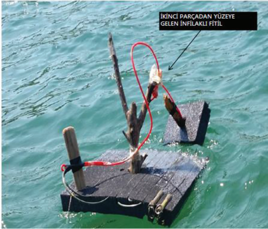
Şekil 4. Sualtı patlatma düzeneği Figure 4. Underwater blasting assembly
