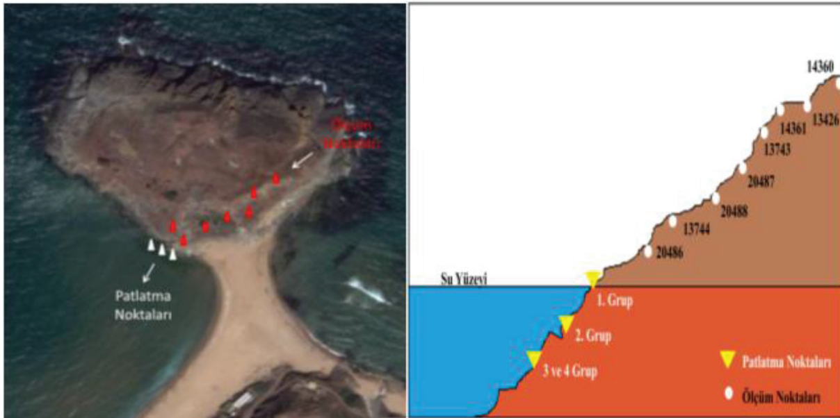
Şekil 3. Patlatma ve titreşim ölçüm noktalarını gösterir uydu ve kesit görüntüsü (1.Dönem)
