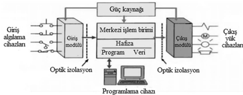
Şekil 1. PLC'nin basit yapısı [5]
