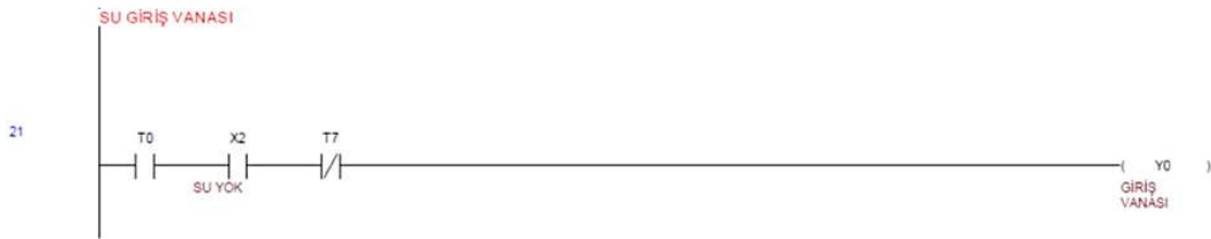
Şekil 5. Sütün siloya doldurulması işlemi için PLC kodu
