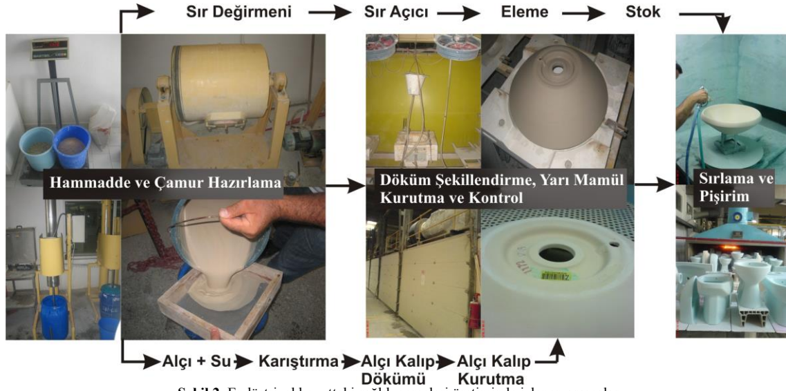
Şekil 2. Endüstriyel boyuttaki sağlık gereçleri üretiminde izlenen aşamalar
