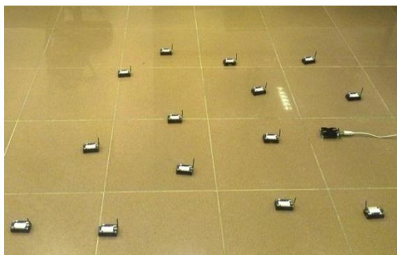
Şekil 10. IRIS düğümleri ve çıkış düğümü
