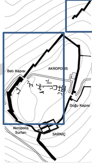
Şekil 33. Metropolis Akropolisi sur yapısında testere ağzı tipinde üretilen duvarlar (Metropolis Kazı Arşivi, 2022)
