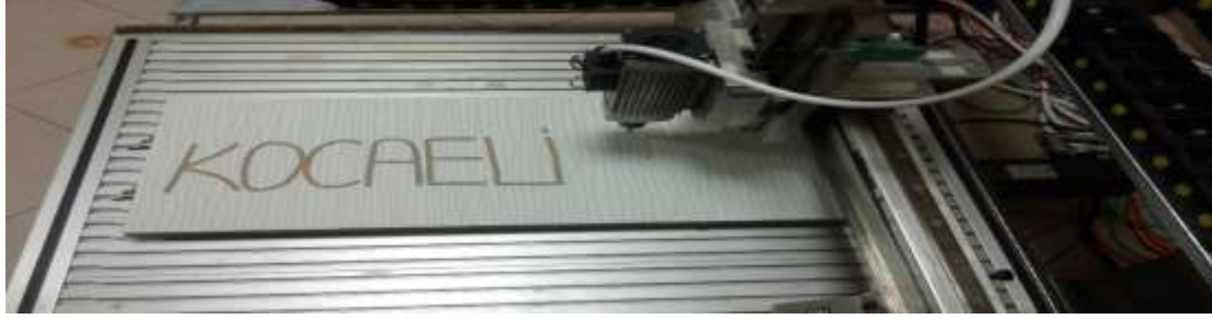
Şekil 16. Kameradan alınan görüntünün prototip CNC sistemde işlenmiş parça görüntüsü
